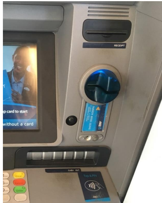
圖 2-13 澳洲無障礙提 ATM 耳機孔及插卡處及提款處點字、卡片感應區
