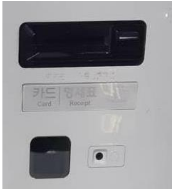
圖 2-9 韓國 ATM 耳機孔及插卡處點字
