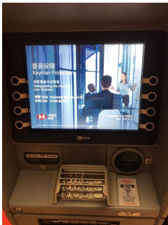
圖 2-17 香港無障礙提 ATM 耳機孔及插卡處及提款處點字、卡片感應區
